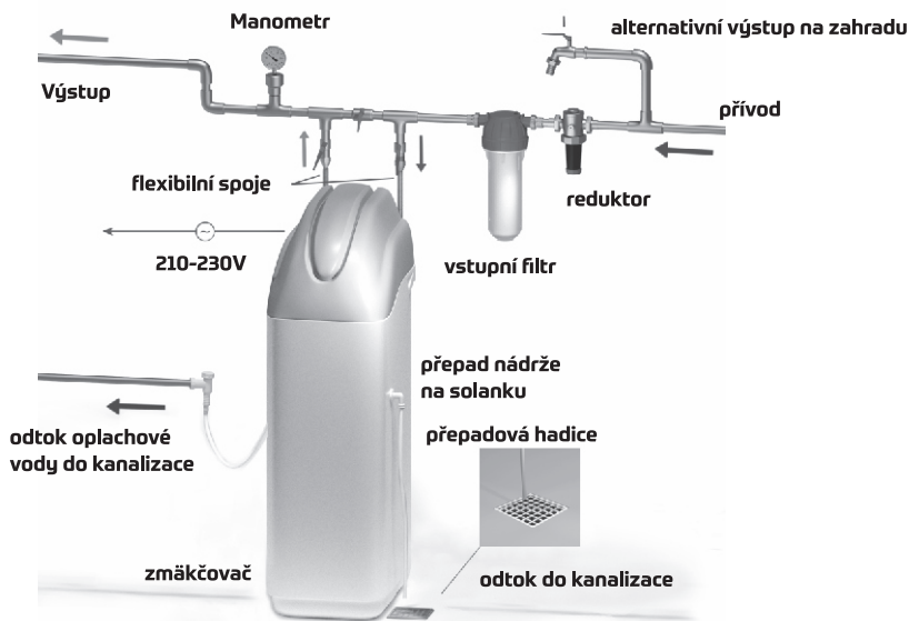
obr.2 Schéma zapojení změkčovače
