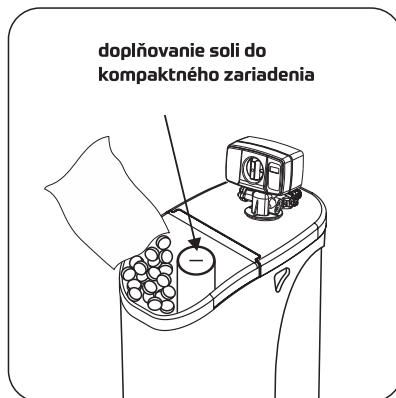
obr. 8 šachta ventilu soľanky
